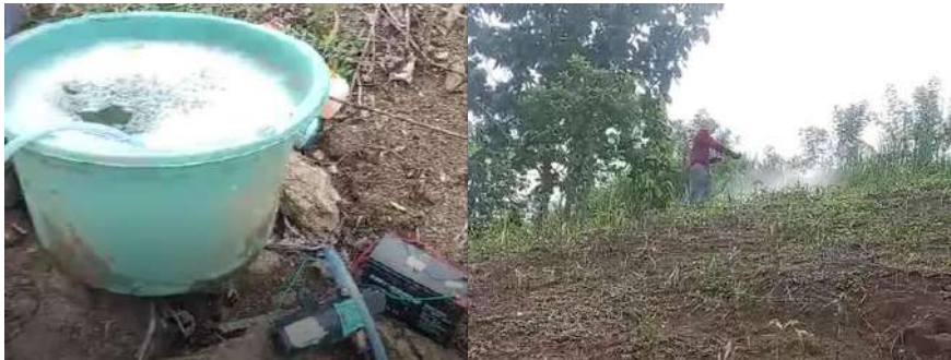
Gambar 3. Alat semprot tanpa tangki gendong yang berhasil dirakit dan telah diaplikasikan oleh warga dikondisi lahan miring.
